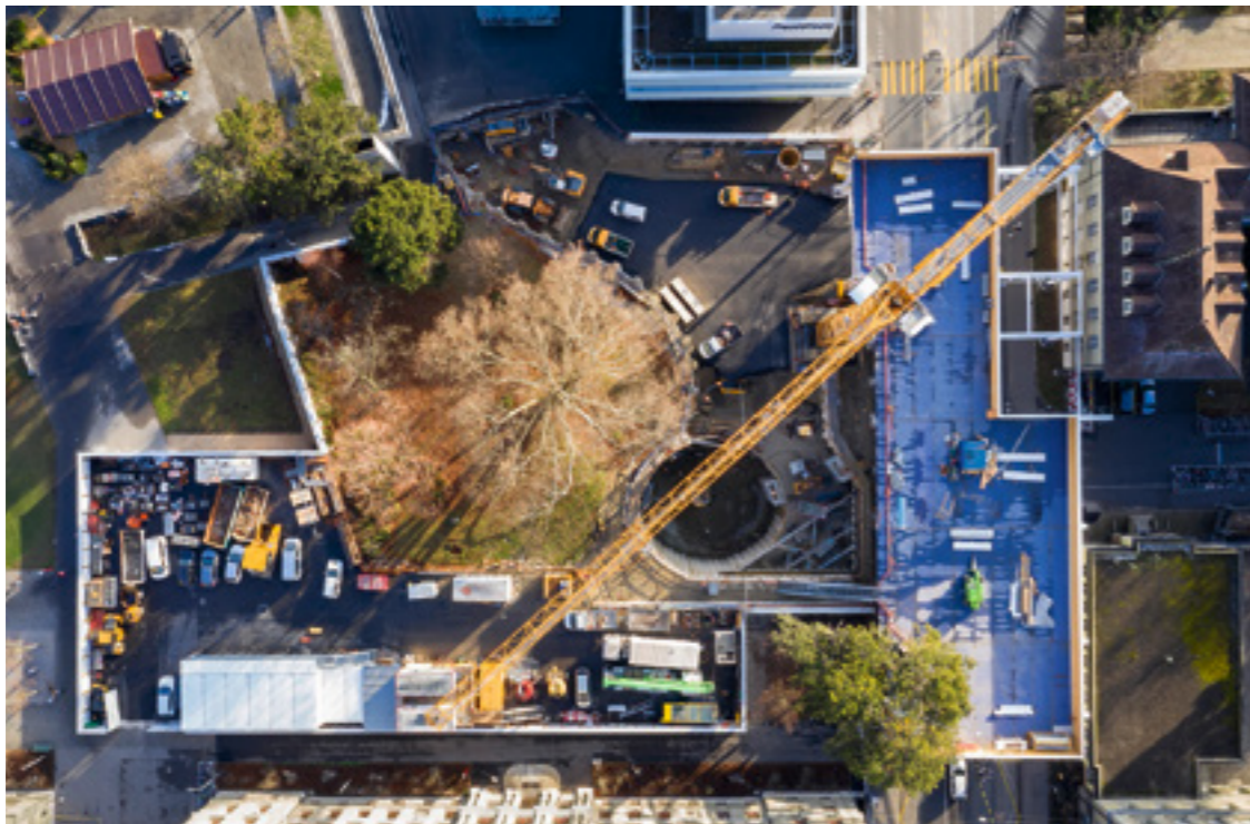
Um mitten in der Stadt Bern in die Tiefe graben zu können, musste man sich Platz schaffen. Als Materiallager dient eine Stahlplattform, die über die viel befahrene Schanzenstrasse führt.
